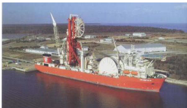
Figura II.2.4-18 - Embarcação típica a ser empregada nas atividades de instalação de dutos pelo método Reel-Lay .
