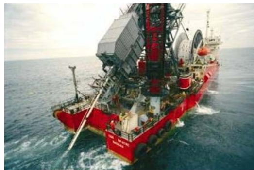
Figura II.2.4-18 - Embarcação típica a ser empregada nas atividades de instalação de dutos pelo método Reel-Lay .
